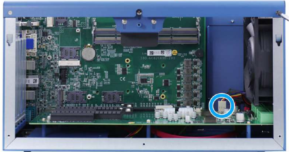
Remove 4-pin fan connector
